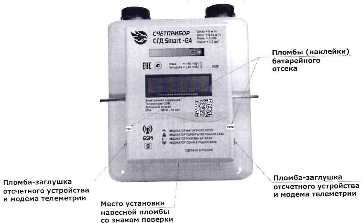
Рисунок 1 – Места расположения контролируемых пломб
